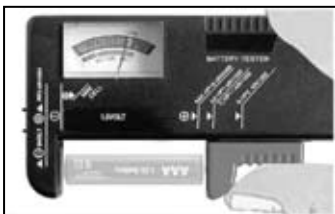
Anschließen der 1,5-V-Batterie
