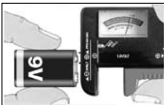
Prova di una pila da 9 V
