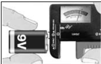
Anschließen der 9-V-Batterie
