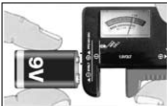
Connexion de la pile de 9 V
