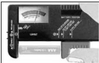
Prova di una pila da 1,5 V
